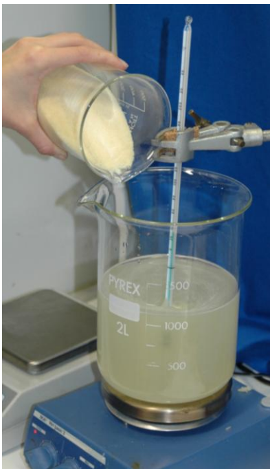
Abbildung 1: Vorbereitung der Gelatine mit einer Heizplatte und einem Rührfisch. Es geht aber genauso gut mit einer Herdplatte und einem Schneebesen. © Plant Biomechanics Group Freiburg 2008
