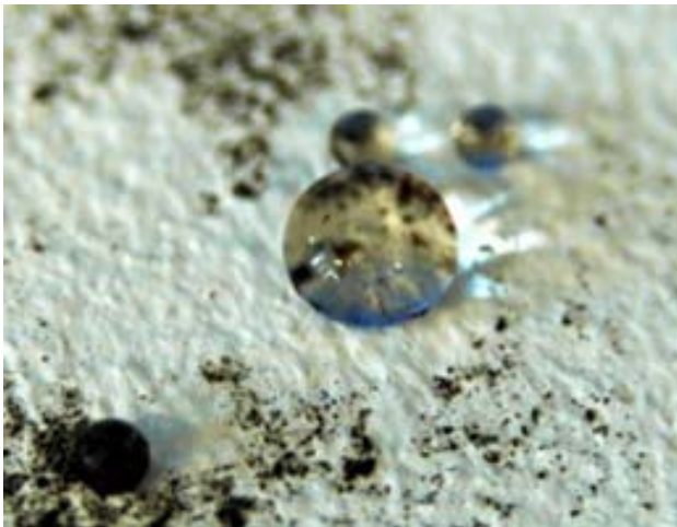
Abb. 3: An einer mit Lotusan® gestrichenen Fläche (hier waagrechte Probefläche) perlen die Wassertropfen ab und reinigen dabei die Oberfläche.
