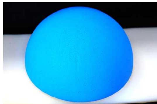
Modell einer Oberfläche ohne Selbstreinigungseffekt: abgeflachtes Wassertröpfchen auf glatter Oberfläche
