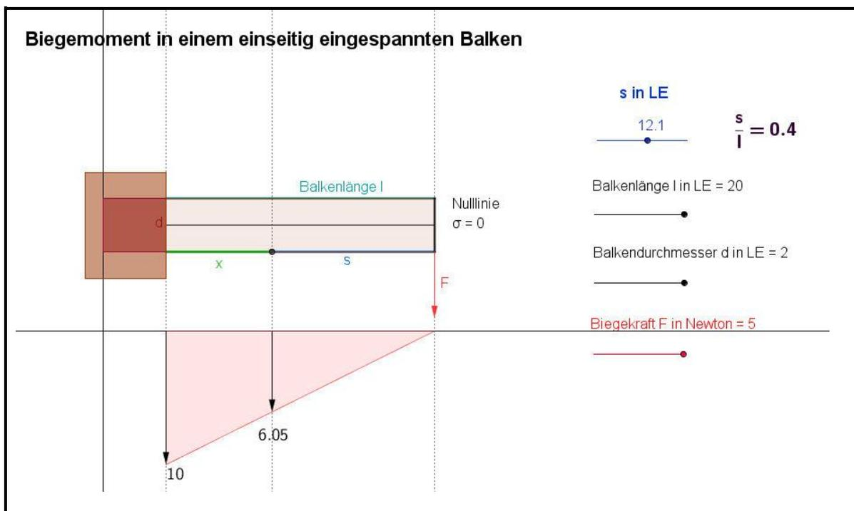
**Vorkenntnisse** — Die Biegespannung setzt sich zusammen aus Zug- und Druckspannungen, daher sind diese Größen Grundlage für das Verständnis des Biegevorgangs. Zwei-, Drei- und Vierpunktbiegung sollten als Methoden bekannt sein, damit keine einseitige Fokussierung auf die im Modell verwendete Zweipunktbiegung stattfindet.
