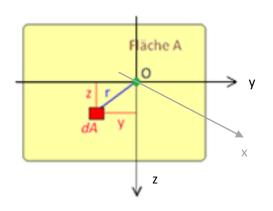
Querschnitt durch einen längs der x-Achse ausgerichteten Körper. Abstand eines Flächenelements dA (rotes Viereck) der Fläche A (gelbes Viereck) zu verschiedenen Bezugsstellen. Diese Beziehung wird in der Berechnung des Flächenträgheitsmoments verwendet. y: Abstand zur z-Achse, z: Abstand zur y-Achse, r: Abstand zum Ursprung des Koordinatensystems.
