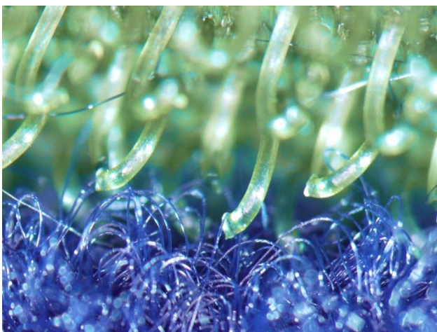
Klettverschluss unter dem Mikroskop mit Hakenband (grün) und Flauschband (blau)
